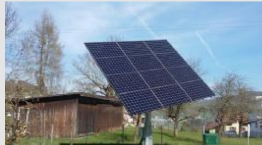
Sonne nach geführter Solargenerator mit 98 % Energiedichte
